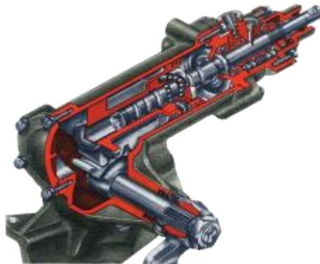
6. Перечислите устройство рулевого управления с гидроусилителем \_\_\_\_\_
